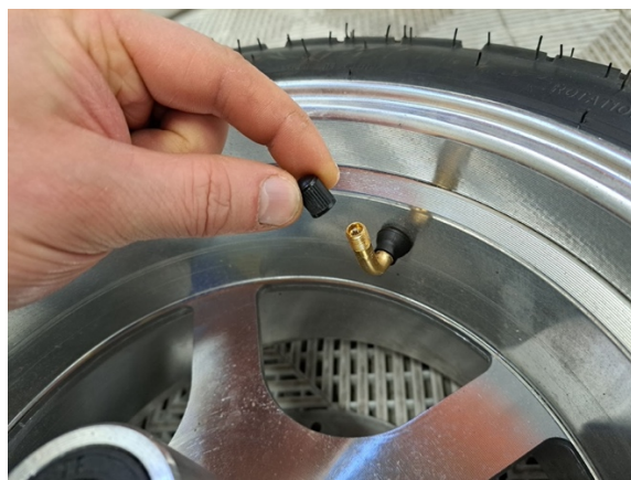
Laita venttiin hattu paikoilleen.
