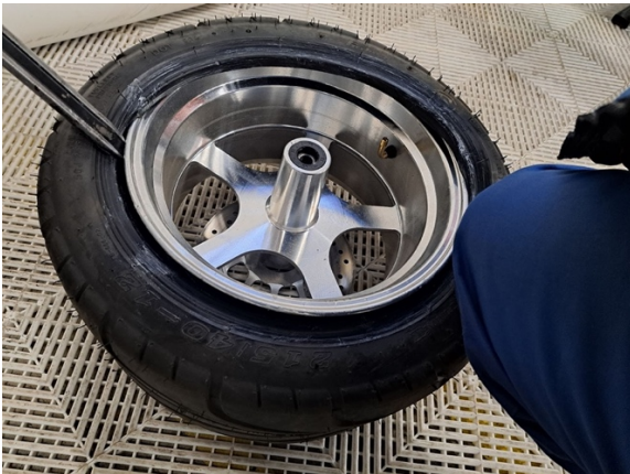
Vääntele rengas vanteelle toiseltakin puolelta.
