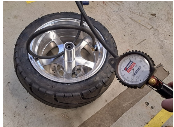
Täytä rengas ilman venttiilin sielua lievään ylipaineeseen (Maksimi 2.5 bar), että rengas asettuu hyvin vanteelle.
