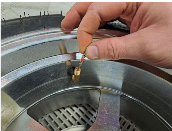
Laita venttiilin sielu venttiliin.
